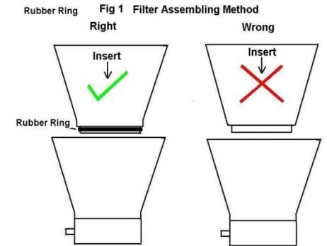
圈套入结合杯底凹槽中。将漏斗底座旋紧在一个 500 毫升的洁净 (GL45 螺旋口) 标准瓶上。侧口接上抽真空的橡皮管)。
